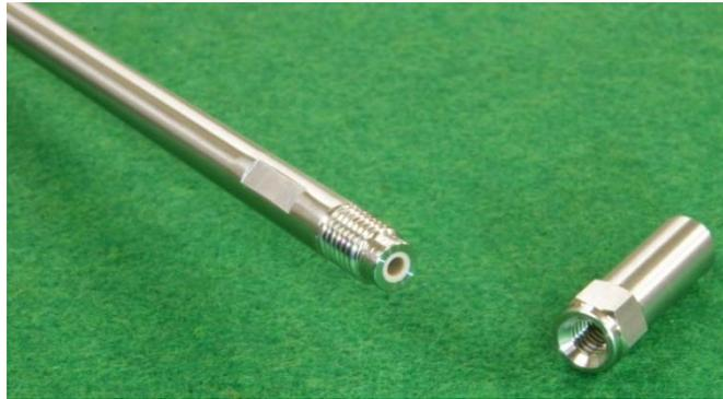
HPLC 用カラムには、分析時間の短縮化を図るために 100MPa 以上の耐圧強度が必要です。従来、外管は SUS316L など一般的なオーステナイトステンレス鋼のシームレスパイプが使用されてきましたが、当社独自の成分設計による高強度オーステナイトステンレス鋼（NKZ304NF）を使用することで、耐圧強度を大幅に高めることができ、複合パイプの小径、軽量化が可能になりました。更に溶接引抜き管のため、従来のシームレスパイプに比べて寸法精度が高く、製造コストも大幅に低減できるメリットがあります。
