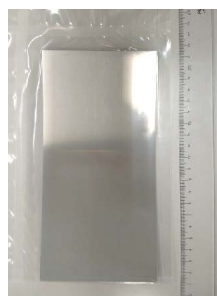
銅添加Mg合金切り板 (0.18mm×100mm×200mm)
