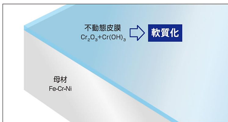
図4 L・DieL 仕上の構造イメージ
